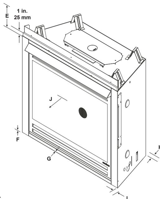
**NOTE:** FRAME OPENING HEIGHT IS GREATER THAN PLASTER OPENING HEIGHT.
