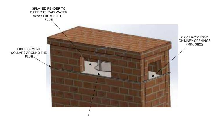
2 x 230mmx172mm CHIMNEY OPENINGS (MIN. SIZE) NOTE: IF CHIMNEY IS MORE THAN 950mm WIDE ,THEN THE TWO OUTLETS ONLY ARE QUITE PRACTICAL ON THE LONG SIDE OF CHIMNEY – WIDTH OF OUTLET TO BE WIDENED IN ACCORDANCE WITH THE LENGTH OF THE CHIMNEY
